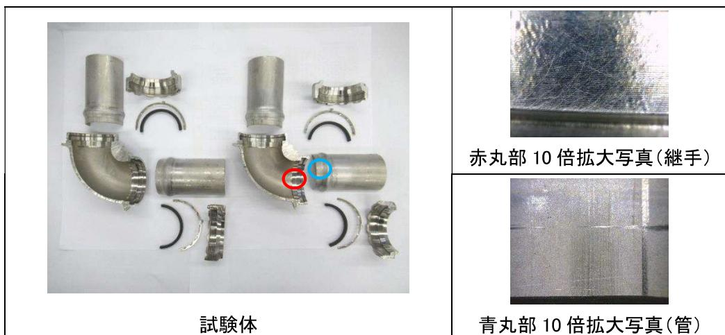
写真 4-8-2 腐食試験結果
