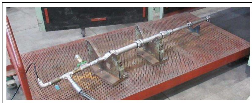
写真 4-6 内圧繰り返し試験状態
