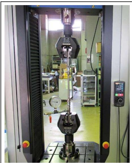
写真 4-4 引抜試験状態
