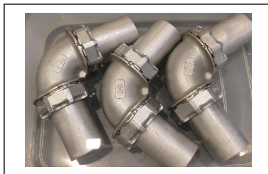
写真 4-8-1 腐食試験(試験中)
