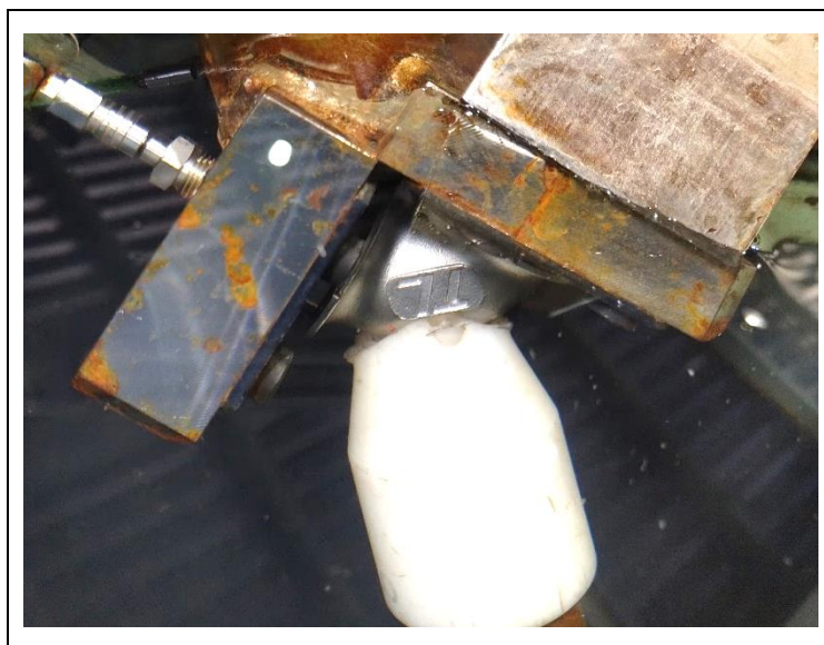
写真 4-1 胴の気密試験
