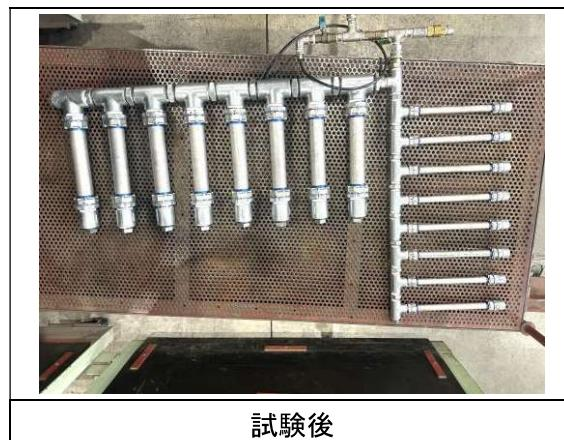
写真 4-18 内圧繰り返し試験状態
