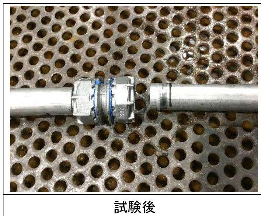
写真 4-12 破壊水圧試験状態
