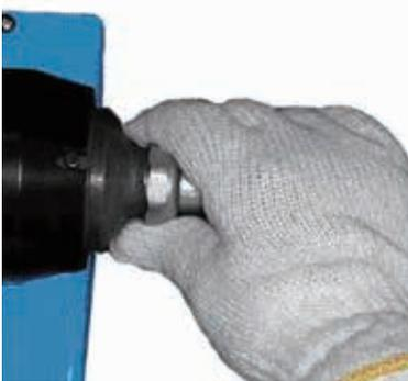
手締めにより、ナットを拡管機のアダプターにねじ込んでください。
