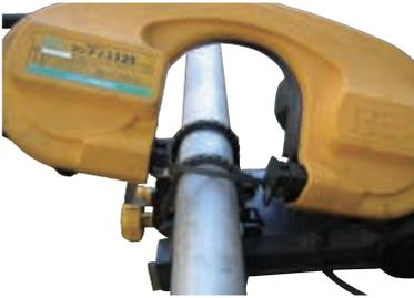
ステンレス鋼管専用の刃などを使用し、メタルソーまたはバンドソーで管を直角に切断します。
