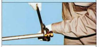
確認マークAを基準に、工具を用いて袋ナットを下記の表の回転数に従って締め付けてください。 締め付けの際は、管の共回りが発生することがあります。 管の反対側がすでに接合されている場合、管をバイスグ リップなどで固定して作業を行ってください。
