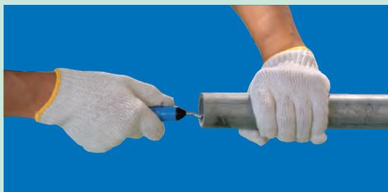
⚠️ 管の鉄地が露出するような面取りは避けてください。また、パーリングリーマーを使用する場合、ライニングを損傷させる恐れがありますので注意しておこなってください。
