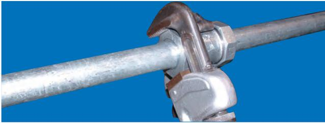
LA型鋼管・塩ビ管の締め付けトルク
