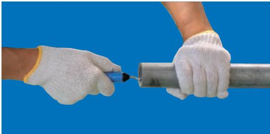
管の鉄地が露出するような面取りは避けてください。また、バーリングリーマーを使用する場合、ライニングを損傷させる恐れがありますので注意しておこなってください。
