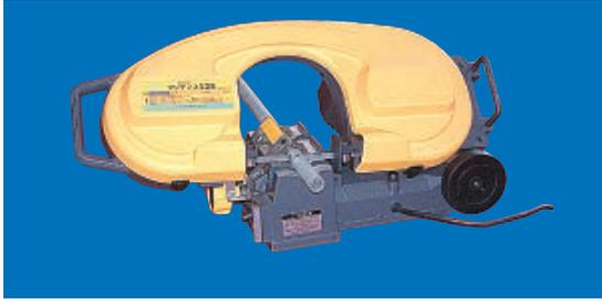
ローラーカッター・高速切断砥石・ガス切断・アーク切断は、管のライニングを損傷させるので絶対に使用しないでください。
