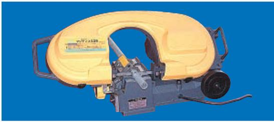
ローラーカッター・高速切断砥石・ガス切断・アーク切断は、管のライニングを損傷させますので絶対に使用しないでください。外面被覆鋼管を切断する場合は、専用のチャックとチェザーを使用してください。
