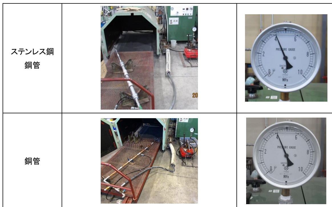
写真 4-6 内圧繰返し試験写真
