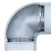
ZD SUS継手の断面(写真) ねじ奥をプレシールしないことで 端材の混入を防止、 接続部の緩み防止に効果あり
