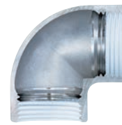
ZD SUS継手の断面(写真) ねじ奥にシール剤を塗布しないことで 端材の混入を防止、 接続部の緩み防止に効果あり
