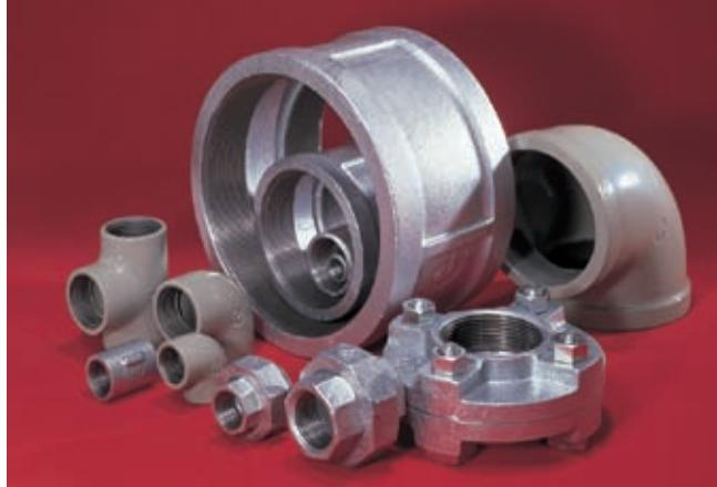
JIS B 2301 「ねじ込み式可鍛鋳鉄製管継手」規格品で、材質は JIS G 5705 可鍛鋳鉄品 (FCMB27-05) を採用しています。
