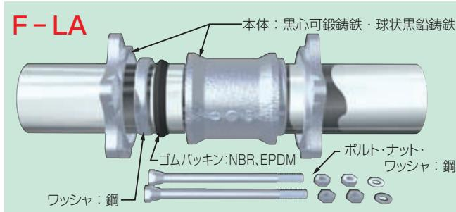
F - LA は、他の LA カップリングと異なり、本体、ゴムパッキン、ワッシャ、フランジ、ボルト・ナットからなり、フランジをボルトで締め付けることによって管にゴムパッキンを圧着します。
